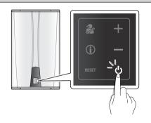
При включении питания на передней панели отображается температура.
