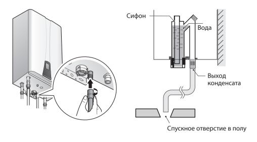
Конец пластиковой трубы 13 мм (резьба NPT) должен выходить в раковину для стирки или в спускное отверстие в полу.
