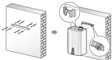
(2) Закрепите кронштейн на стене с помощью самонарезающих болтов и анкеров.
