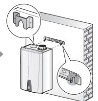
Поднимите водонагреватель, установите прибор на крюках кронштейна для настенного
