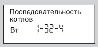
Каждому водогрейному котлу специалистом по отопительной технике присваивается определенный номер котла. В основной индикации указана актуальная фактическая последовательность котлов:
