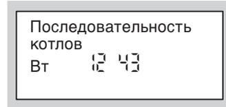
Критерии для последовательности котлов (например, постоянный ведущий котел, последний котел) устанавливаются местным специалистом по отопительной технике при вводе в эксплуатацию отопительной установки. Вы можете в рамках этих критериев изменить последовательность эксплуатации котлов.
