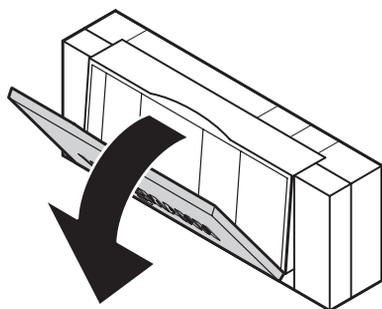
Блок управления находится за защитной крышкой. Чтобы открыть, нужно потянуть крышку за передний край вперед.
