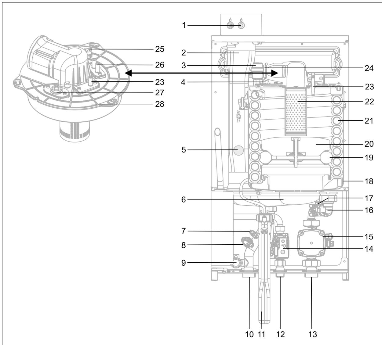
**Рис. 4.1** Схема конструкции газового конденсационного котла
