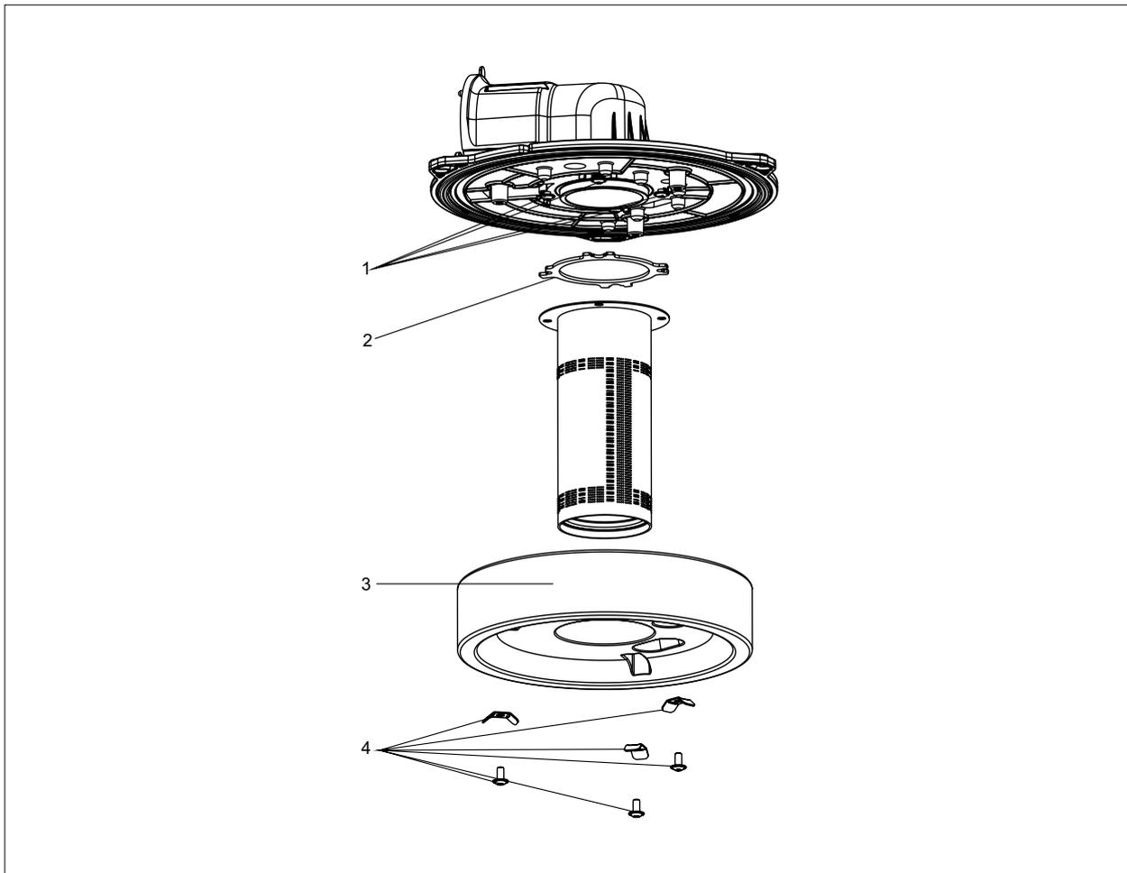
**Рис. 6.2 Разборка горелки**
