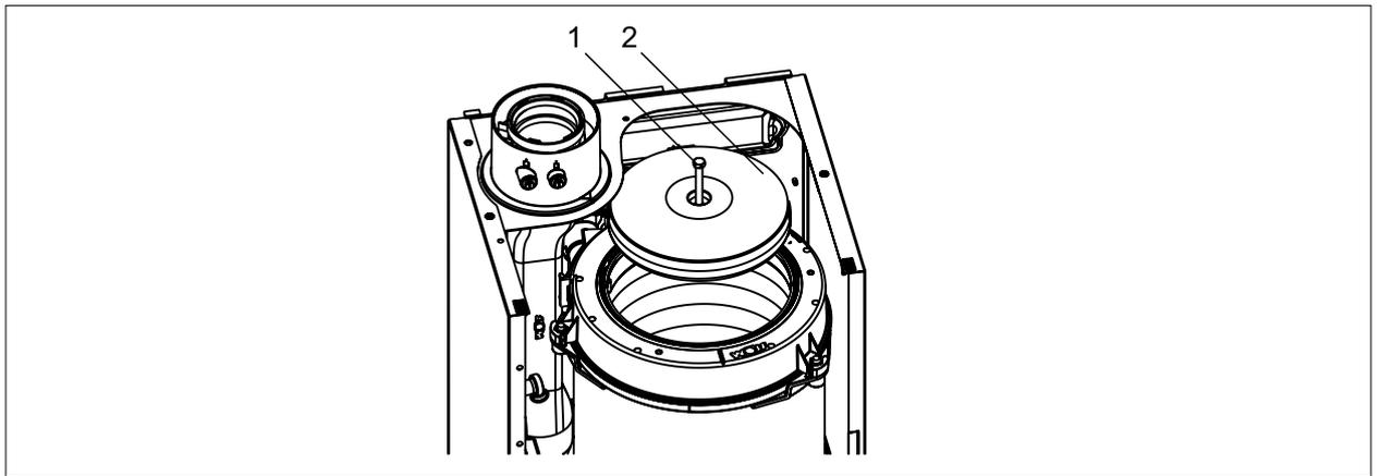
Рис. 6.6 Верхняя часть кожуха камеры сгорания
