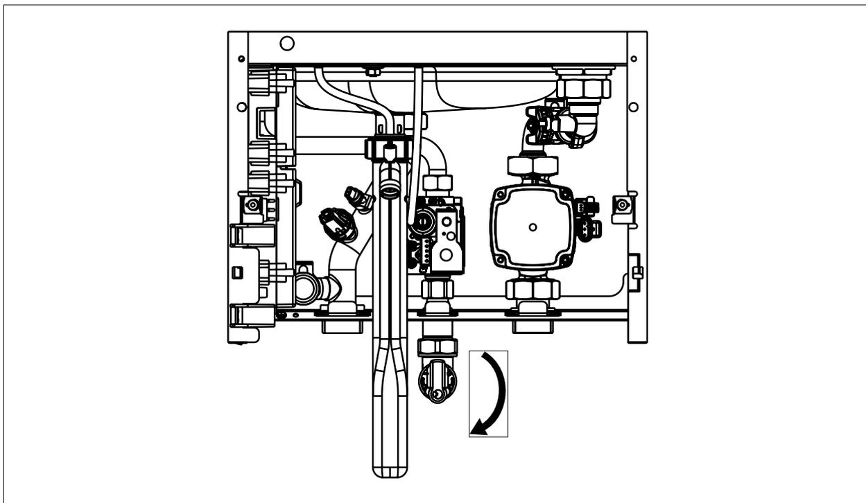
Рис. 5.2    Закрытие газового крана
