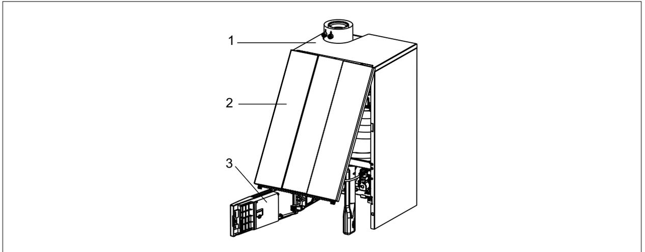
**Рис. 6.13** Монтаж крышки устройства и передней облицовки
