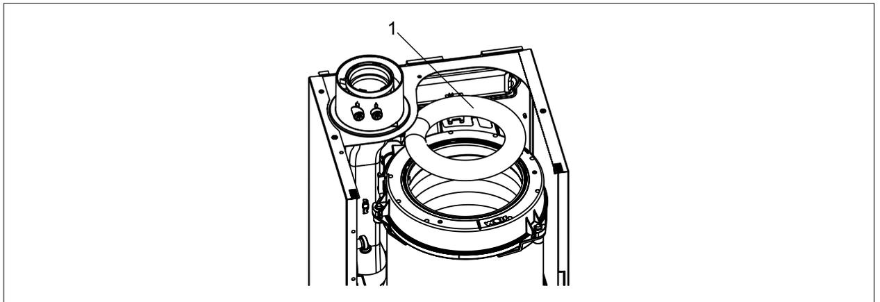
Рис. 6.7 Извлечение изолирующей втулки
